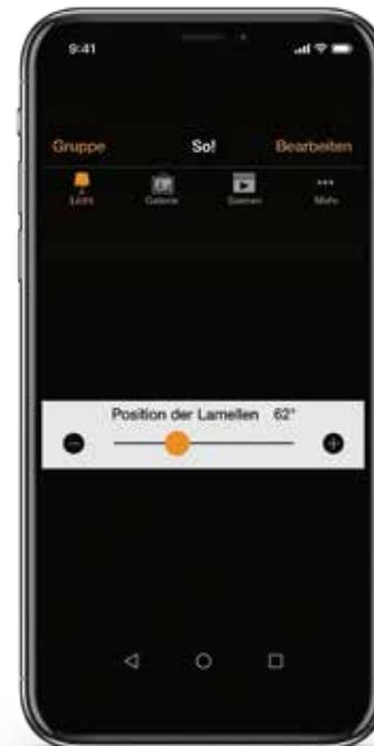
Ideal für alle, die selbst gerne das Heft in die Hand nehmen: Legen Sie den Öffnungsgrad der Lamellen selbst fest. Mit dem Roller können Sie die gewünschte Position (zwischen 0° und 145°) festlegen, indem Sie die Lamellenposition von links nach rechts schieben. Dies funktioniert auch manuell über die in den Pfosten integrierten Designtasten.
