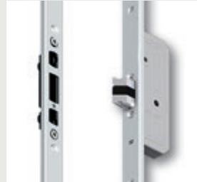
Beim Schließen der Tür fahren automatisch zwei stabile Fallenriegel im oberen und unteren Bereich der Tür aus und bewirken eine Mehrfachverriegelung, die nicht vergessen werden kann. Die Fallen sind mit einer Rückdrück-sicherung ausgestattet, als zusätzliches Sicherheitsplus.
