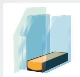
Durchwurffhemmende P4A Verglasung hält mit der hochreißfesten Folie gesplitterte Scheiben fest im Verbund zusammen. Mittels Spezialkleber verschmilzt das Glas zu einer festen Einheit mit dem Flügel und erschwert das gewaltsame Entfernen.
