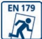
**NOTAUSGÄNGE (DIN EN 179)** sichern Fluchttüren, bei denen das Publikum mit der Funktion vertraut ist und zudem nicht mit einer Paniksituation gerechnet wird, das kann zum Beispiel in Bürogebäuden oder Werkstätten der Fall sein.
