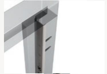
Aus hochwertigem gebürstetem Edelstahl bestehen sowohl Schlossstulp als auch Schließleiste. Beide sind durchgehend auf voller Länge und in U-Form gekantet und in das Holz eingelassen. Diese Variante stabilisiert nicht nur, sie verhindert zuverlässig das Hintergreifen mit Aufhebelwerkzeugen.
