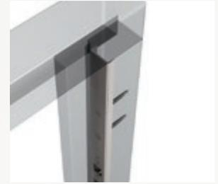
Aus hochwertigem gebürstetem Edelstahl bestehen sowohl Schlossstulp als auch Schließbleiste. Beide sind durchgehend auf voller Länge und in U-Form gekantet und in das Holz eingelassen. Diese Variante stabilisiert nicht nur, sie verhindert zuverlässig das Hintergreifen mit Aufhebelwerkzeugen.
